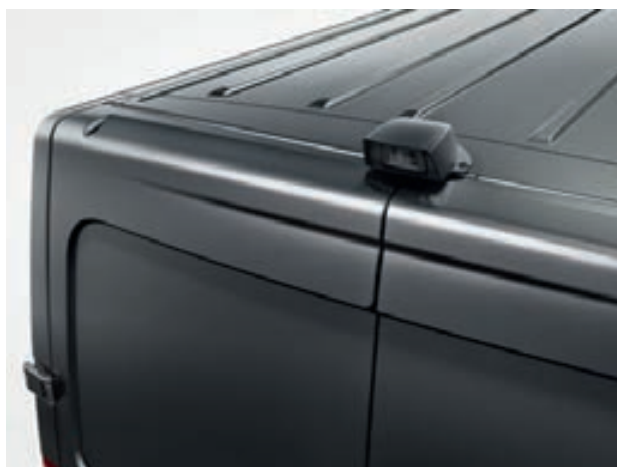
3 PERMANENT SIKT BAKOVER med et kamera plassert på taket bak, for å kunne se som med et innvendig speil under kjøring.
