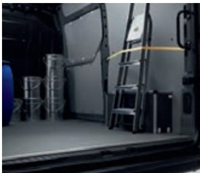
Vegger på sidene og gulv med antisklibelegg i 6 mm polypropylen
